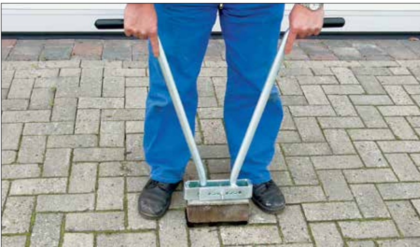
Figur 4.17. Der findes forskelligt specialværktøj til betonstensarbejde, bl.a. til optagning af sten.
