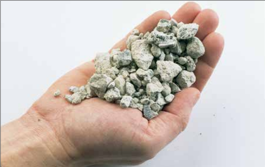
Figur 2.54. Udtjent beton knuses let ved hjælp af knuseanlæg og sorteres i ønskede kornstørrelser. Knust beton kan anvendes i ny beton eller til opbygning af bærelag.
