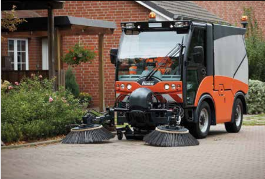
Figur 4.3. Der skal udvises forsigtighed ved anvendelse af feje-/sugemaskiner på belægninger med fuger, da der er risiko for at fugematerialet suges op.
